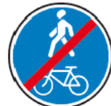
4.5.3 Конец пешеходной и велосипедной дорожки с совмещенным движением (конец велопешеходной дорожки с совмещенным движением)
